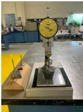
Figure A.4 : Mesure de la résistance au cisaillement non drainée de l'argile en utilisant le cône suédois
