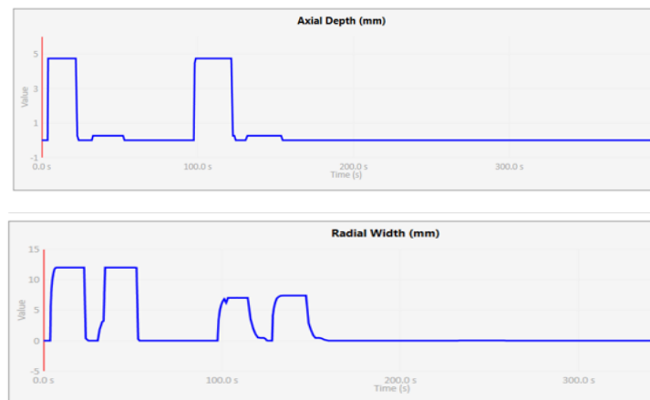
Figure 9.4 : Résultats obtenus par le logiciel VERICUT pour le calcul de la profondeur axiale et radiale.
