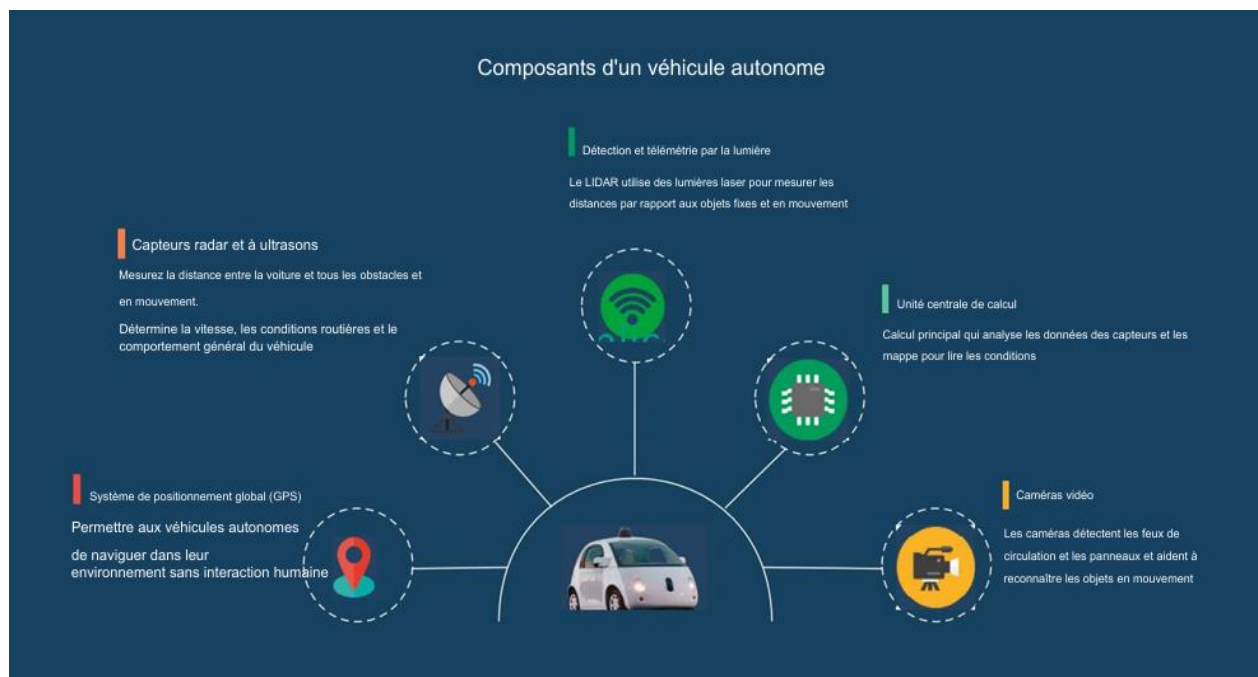
Figure 2.1 Composants d'un véhicule autonome. © Bathla et al., 2022. Reproduit avec permission
