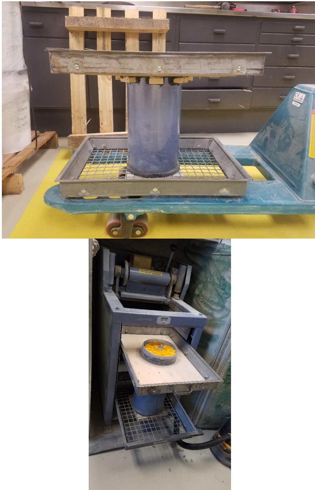
Figure 7.1: Images du dispositif expérimental pour les essais de ségrégation sous vibration horizontale.
