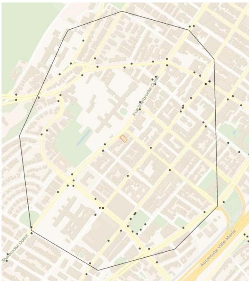
Figure 4.19 Voisinage représenté par un isochrone autour d'un polygone à une vitesse à vélo de 12.0km/h et un temps de parcours de 4 minutes
