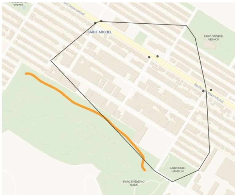
Figure 4.18 Voisinage représenté par un isochrone autour du centroïde d'une ligne à une vitesse de marche de 4.5km/h et un temps de parcours de 10 minutes
