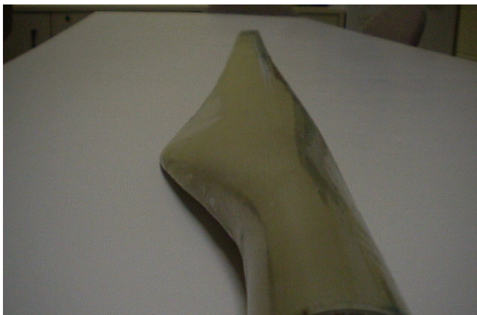
FIGURE 6.10 : Vue en angle d'une pale fabriquée par infusion sur vessie sacrificielle fermée.
