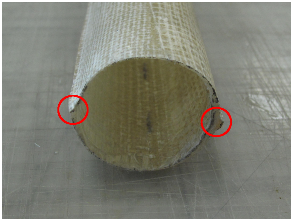
FIGURE 6.12 : Défauts engendrés par le pincement des fibres.
