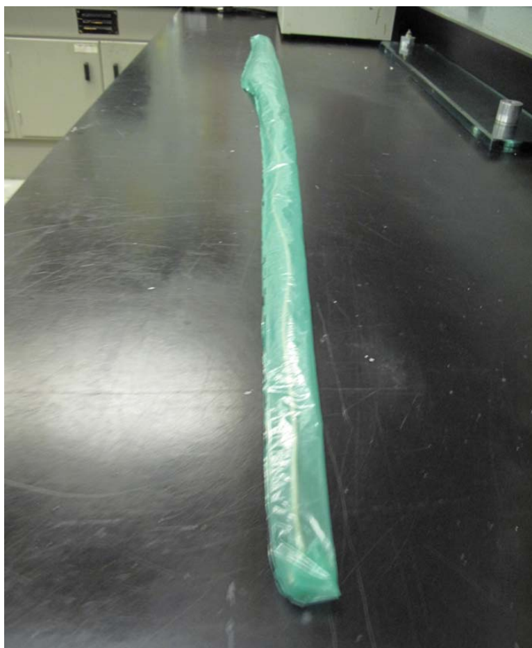
FIGURE 6.2 : Vessie fermée servant à la fabrication de la pale.
