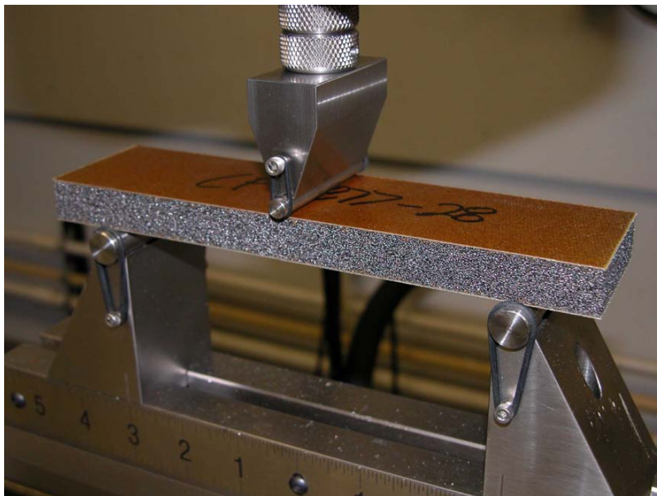
FIGURE 4.18 : Mesure du cisaillement du noyau, par la norme ASTM C 393/C 393M-06.
