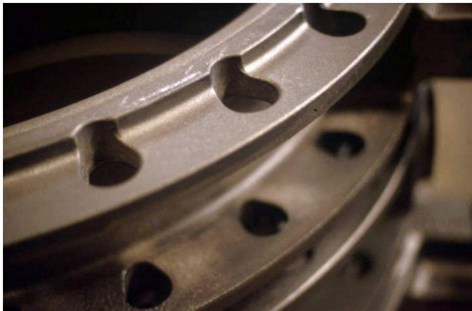
FIGURE 4.4 : Exemple de pièces produites par le procédé « V-Process ».
