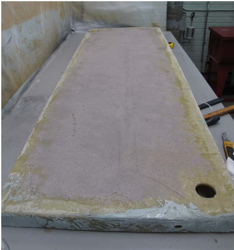
FIGURE 5.14 : Traitement de surface des parois du moule qui seront en contact avec le sable.
