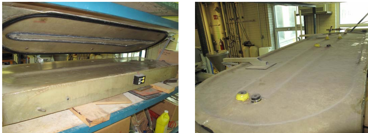
FIGURE 5.18 : Assemblage des parties inférieure et supérieure du moule.
