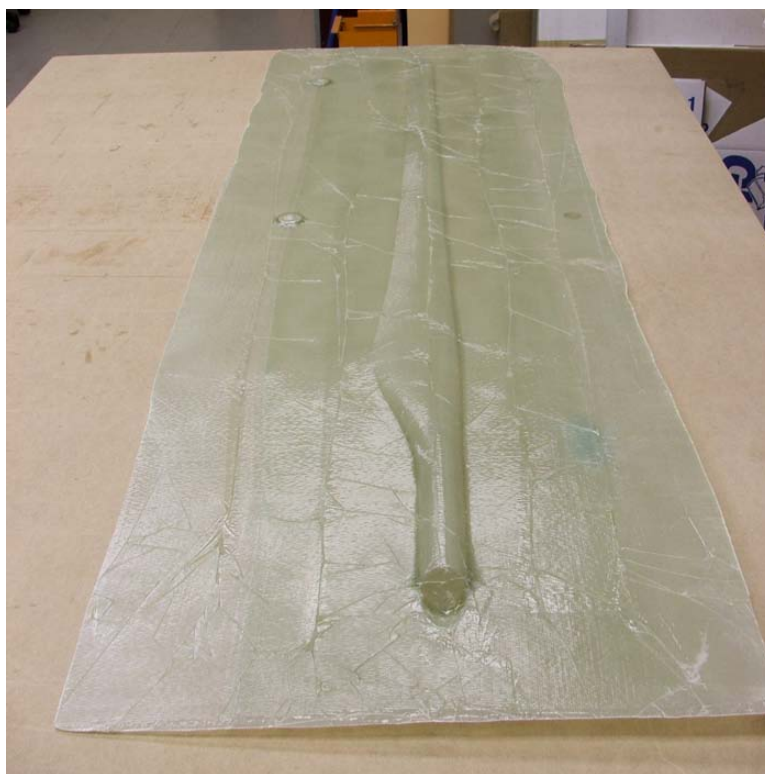
FIGURE 5.11 : Couche de surface de la partie inférieure du moule.
