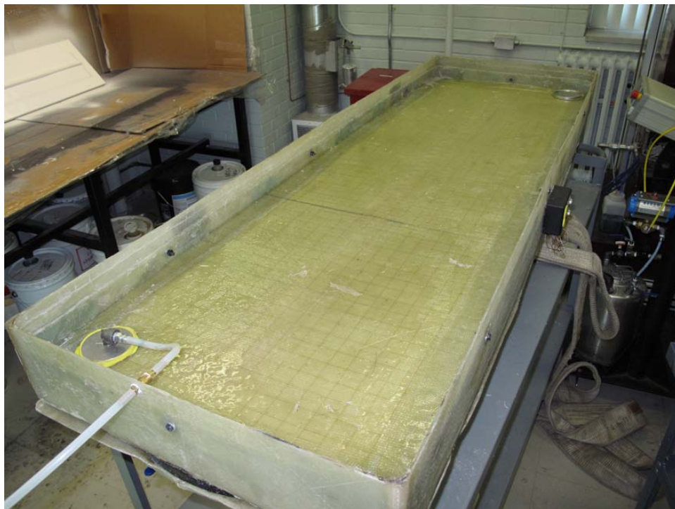
FIGURE 5.16 : Assemblage final du moule inférieur.
