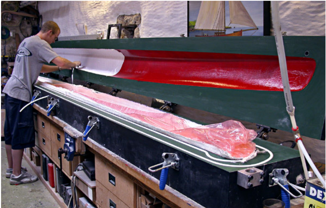
FIGURE 3.3 : Moule dédié à la fabrication par injection sur vessie pressurisée.
