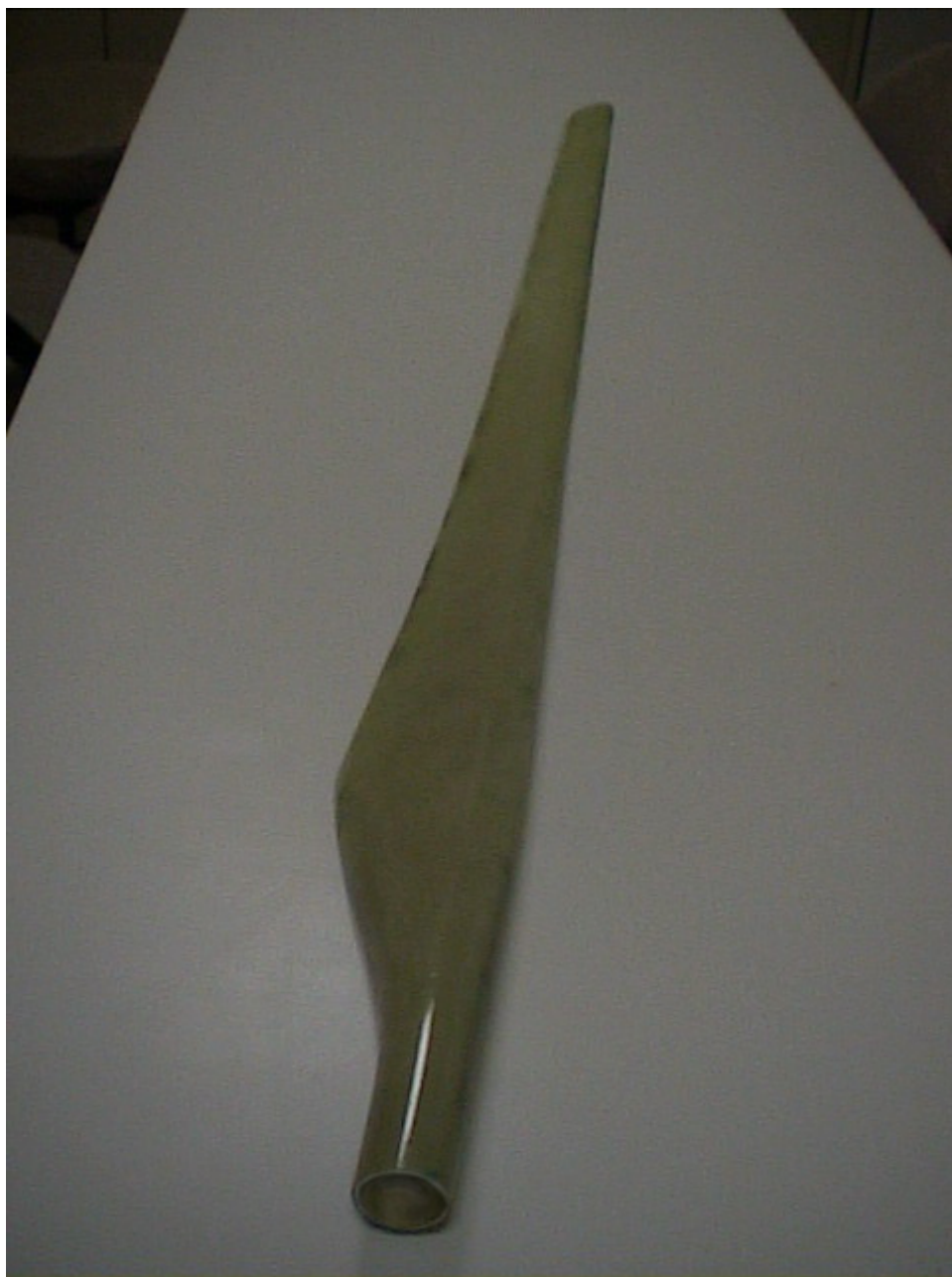
FIGURE 6.9 : Exemple de pale fabriquée par infusion sur vessie sacrificielle fermée.
