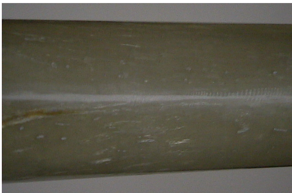
FIGURE 6.11 : Fini de surface d'une pale fabriquée par infusion sur vessie sacrificielle fermée.
