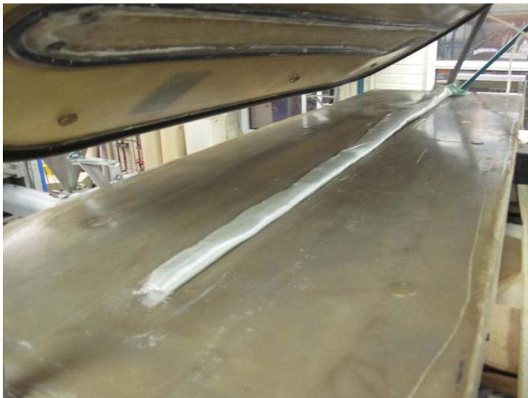
FIGURE 6.4 : Positionnement de la préforme dans le moule.
