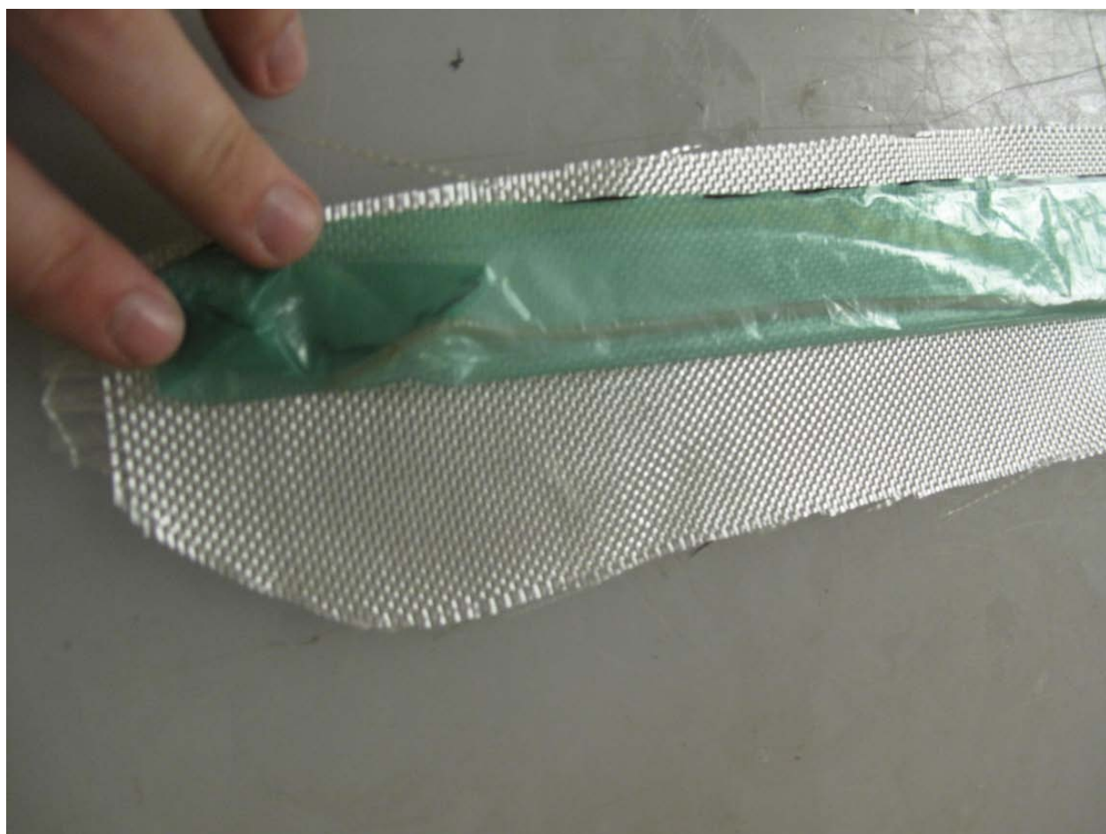
FIGURE 6.1 : Ficelle de démoulage attachée à l'extrémité de la vessie et laissée pour l'étape de démoulage.
