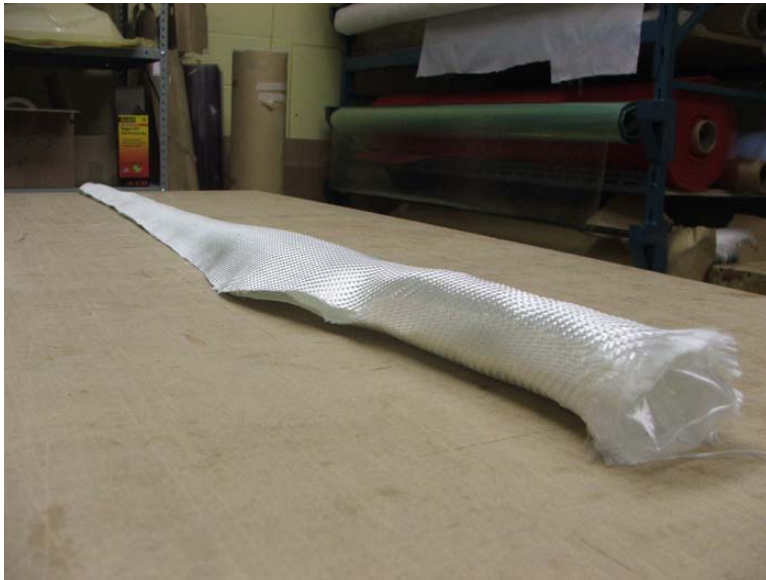
FIGURE 6.3 : Préforme de fibres enroulée autour de la vessie fermée, présentée avant le placement dans le moule.
