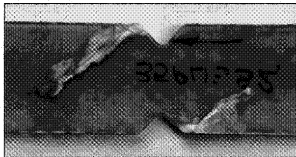
Figure 3.61 - Endommagement des échantillons de cisaillement à renforts tressés aux points d'appui
