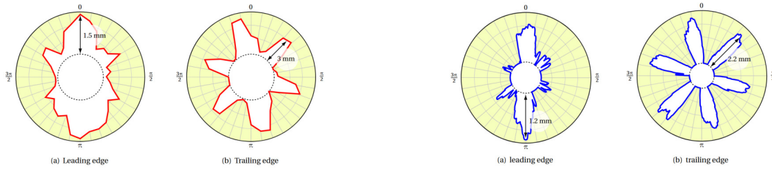
(a) Illustration des lobes BA BF sur le carter expérimentale. (b) Illustration des lobes BA BF sur le carter numérique.
