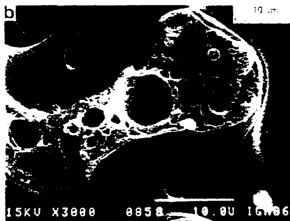
Figure 2.1: Structure d'une goutte composite pour un mélange PP/PC à 60% de PC vu au microscope électronique à balayage (Favis et Chalifoux, 1988).
