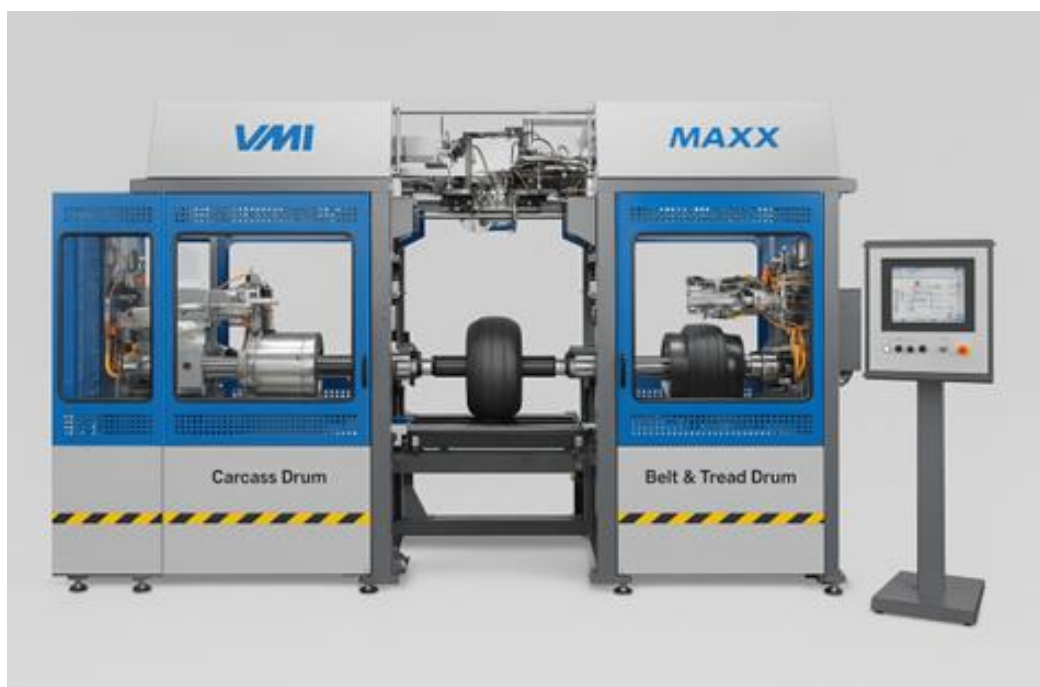
Figure 4.1 Processus d'assemblage avec la machine VMI MAXX
