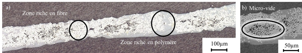
Figure 5.3: Images de micrographie, a) Micrographie du ruban préimprégné, b) Zoom sur une zone de vide
