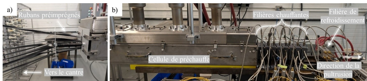
Figure 4.1: Image de la ligne de pultrusion: a) Entrée des rubans préimprégnés, b) Ligne de pultrusion
