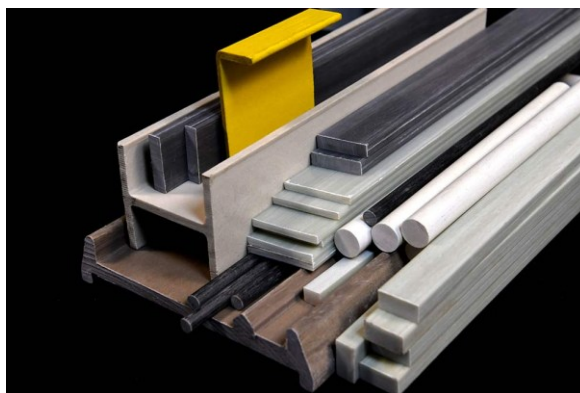
Figure 1.3: Différentes sections faites en pultrusion [8]
