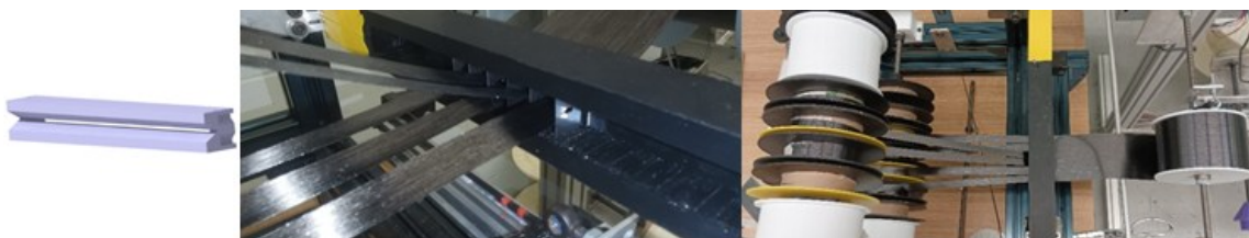
Figure 4.10: Méthode de découpe par lame
