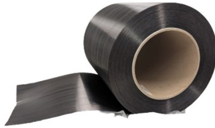
Figure 4.2: Image de la bobine de 304.8 mm de large (12 pouces). APC(CF/PEKK), Syensqo
