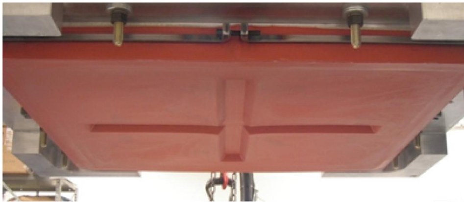
Figure 6-1 : Membrane flexible tridimensionnelle développée pour la mise en forme de panneaux auto-raidis.
