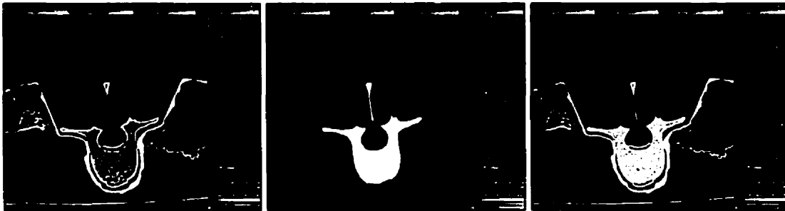
Figure 2.2 - Détection des contours : de gauche à droite, image DICOM d'une tranche, aires délimitées (informations du fichier .tag pour deux vertèbres) et superposition des aires, en transparence, à l'image (tirées du logiciel SliceOmatic)
