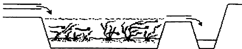
Figure 3.3 : Système avec plantes submergées (adapté de Brix, 1993)
