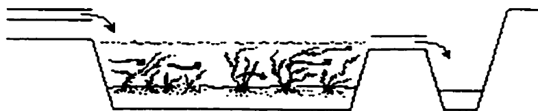
Figure 3.3 : Système avec plantes submergées (adapté de Brix, 1993)
