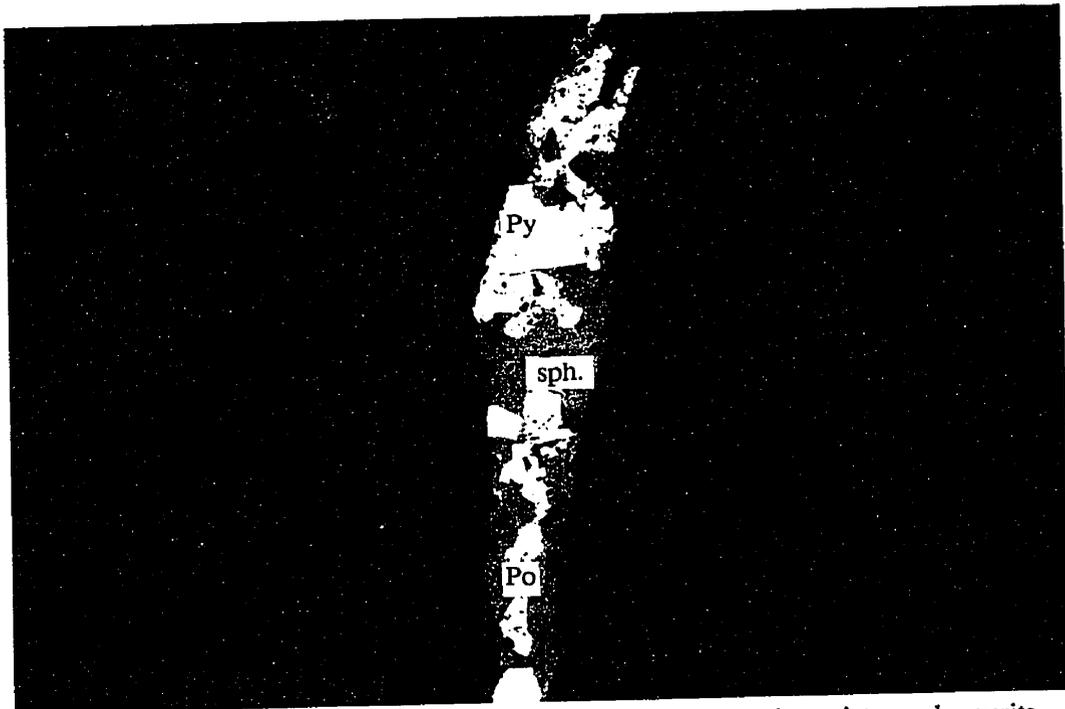
Figure 6.8: Sphalérite, associée à la pyrrhotite et cimentant des cristaux de pyrite, s'organise en lamine orientée dans la minéralisation rythmée (LR 58X).
