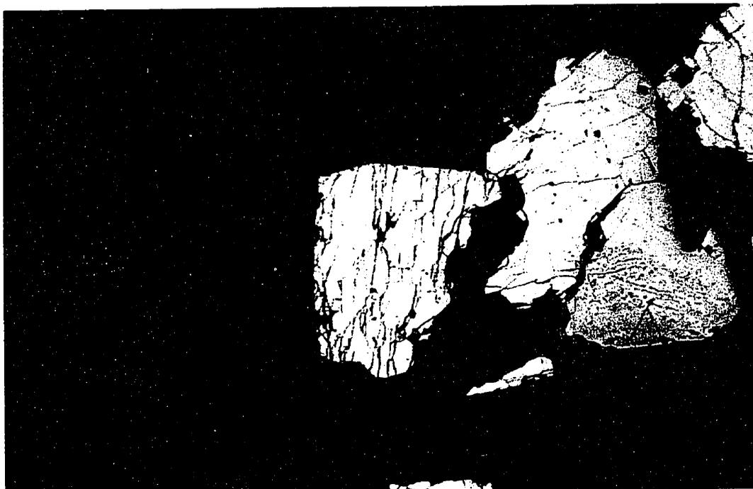
Figure 6.57: Pyrite primaire grossière montrant des microfissures causées par la cataclase (LR 115X).
