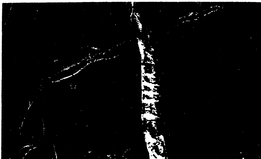
Figure 1.1. Microphotographie de section droite d'une soudure avec fissure, X 1500, par SEM (Rollin et al., 1991)
