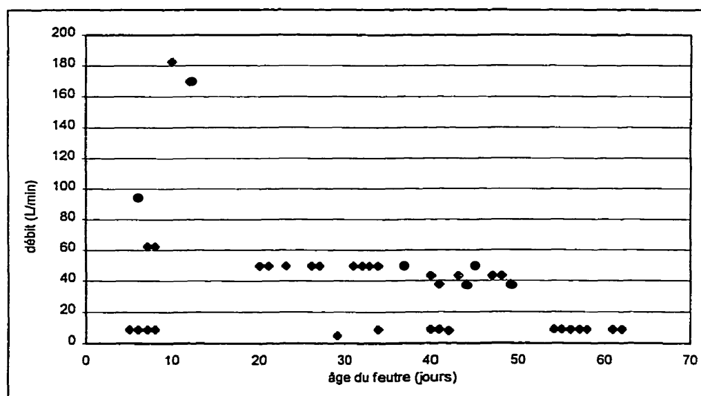
Figure 3.2: Débit boîte à vide feutre inférieur versus âge du feutre.
