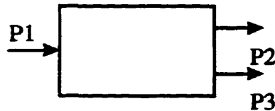
Figure 4.8: Division de puissance
