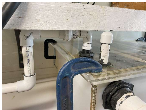
Figure C 3 Scellement du couvercle du décanteur
