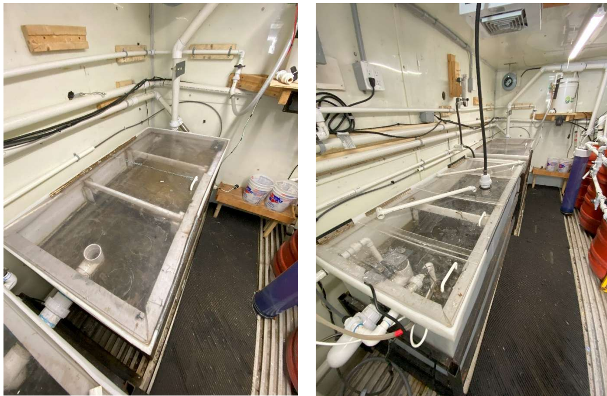
Figure C 1 Fosse septique et réacteur à biofilms dans le conteneur convertit à laboratoire
