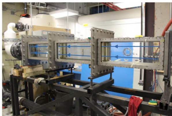
FIGURE 4.3 Schéma (à gauche) et photographie (à droite) de la boucle hydrodynamiques A106 extrait de T. Ledoux [18] . Au centre de la photographie, on voit les veines d'essais transparentes où se déroulent les expériences, les flèches bleues représentant le sens du courant
