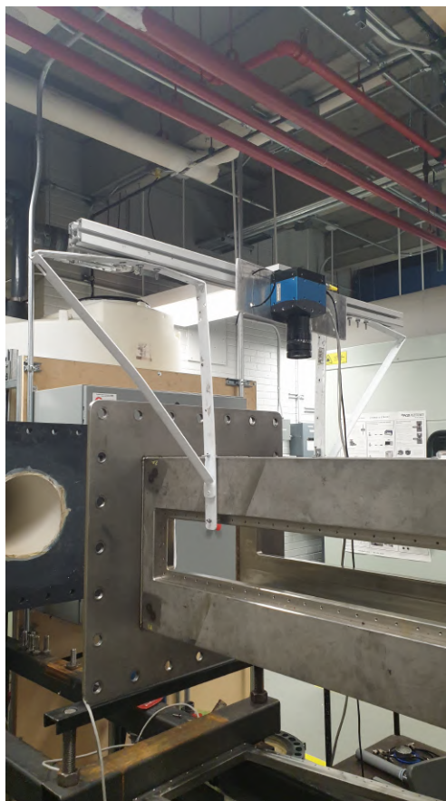
FIGURE 4.4 Portique permettant à la caméra de surplomber la section pour permettre la capture vidéo des expériences.
