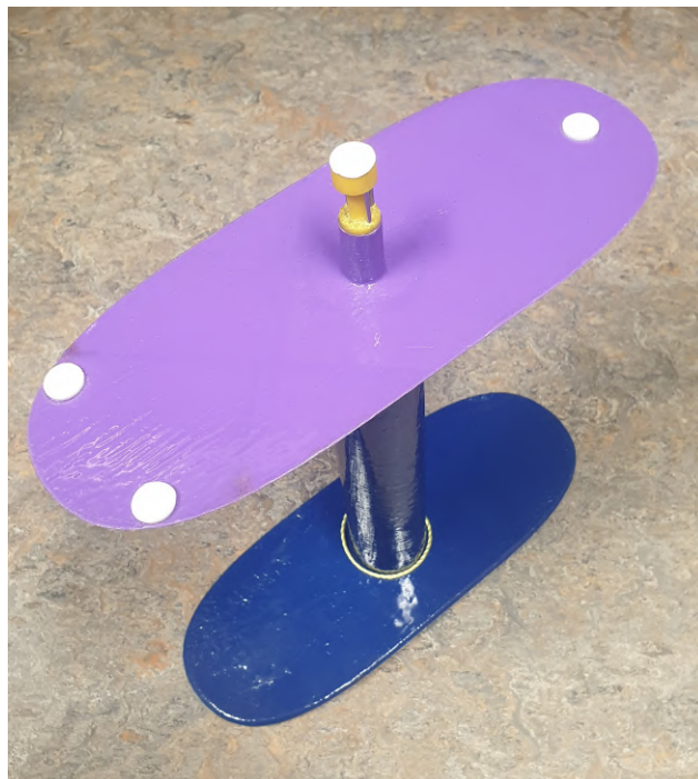
FIGURE 4.2 Système imprimé en ABS comportant le cylindre, les splitter plates , le cylindre surélevé permettant la liaison avec les ressorts et les patins en téflon.
