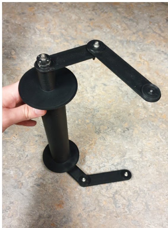
FIGURE 5.14 Photographie du prototype imprimé en 3D du nouveau système se basant sur un cylindre en fibre de carbone.
