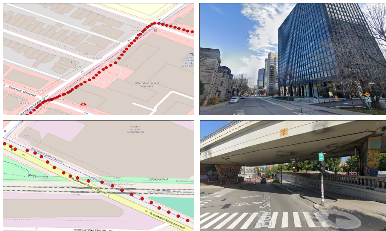
Figure 3.1 Exemples de perturbations des traces GPS (gauche) à cause de l'environnement bâti (droite)
