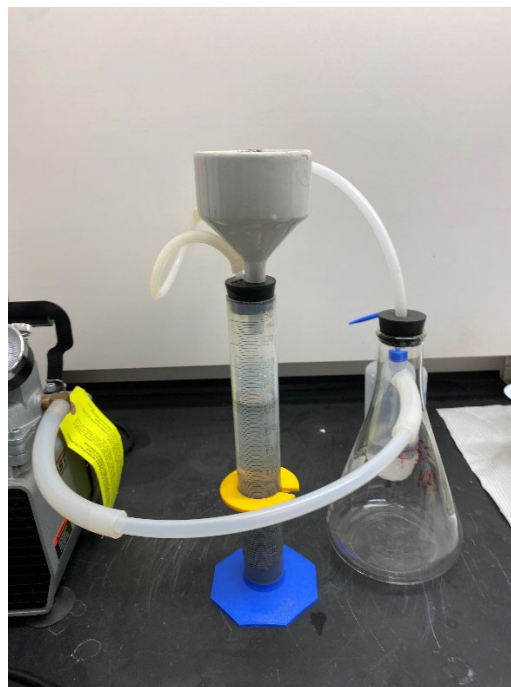
Figure 3-2 Montage utilisé pour les essais de filtration
