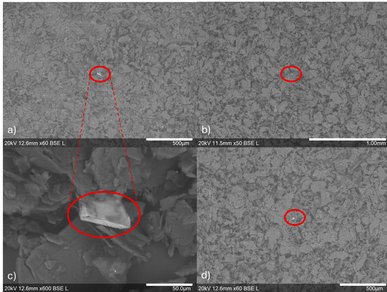
Figure 6-6 Images MEB des graphites finaux pour différents niveaux de dopage - a) 50%, b) 100%, grains d'impuretés présents dans le graphite final des essais réalisés avec des dopages de - c) 50% et d) 200%
