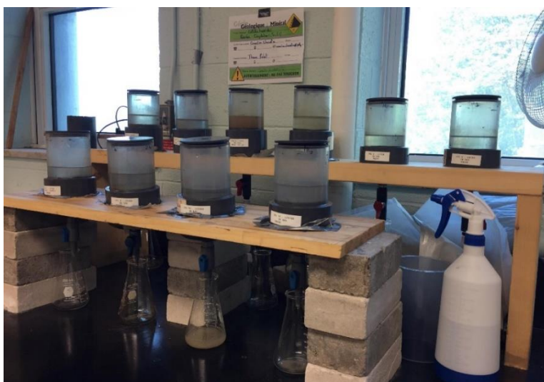
Figure 3.1 Cellules utilisées au laboratoire de Polytechnique. Photo réalisée à la fin du montage de la première phase d'essais et au début du premier cycle de rinçage
