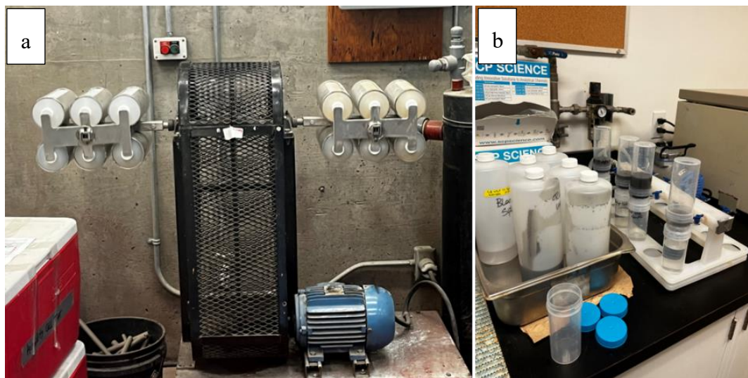
Figure 3.5 : Photos de quelques dispositifs utilisés lors des essais TCLP et SPLP : a- agitateur rotatif à vitesse variable et b- appareil de filtration avec membrane de 0,45 \mu\text{m}
