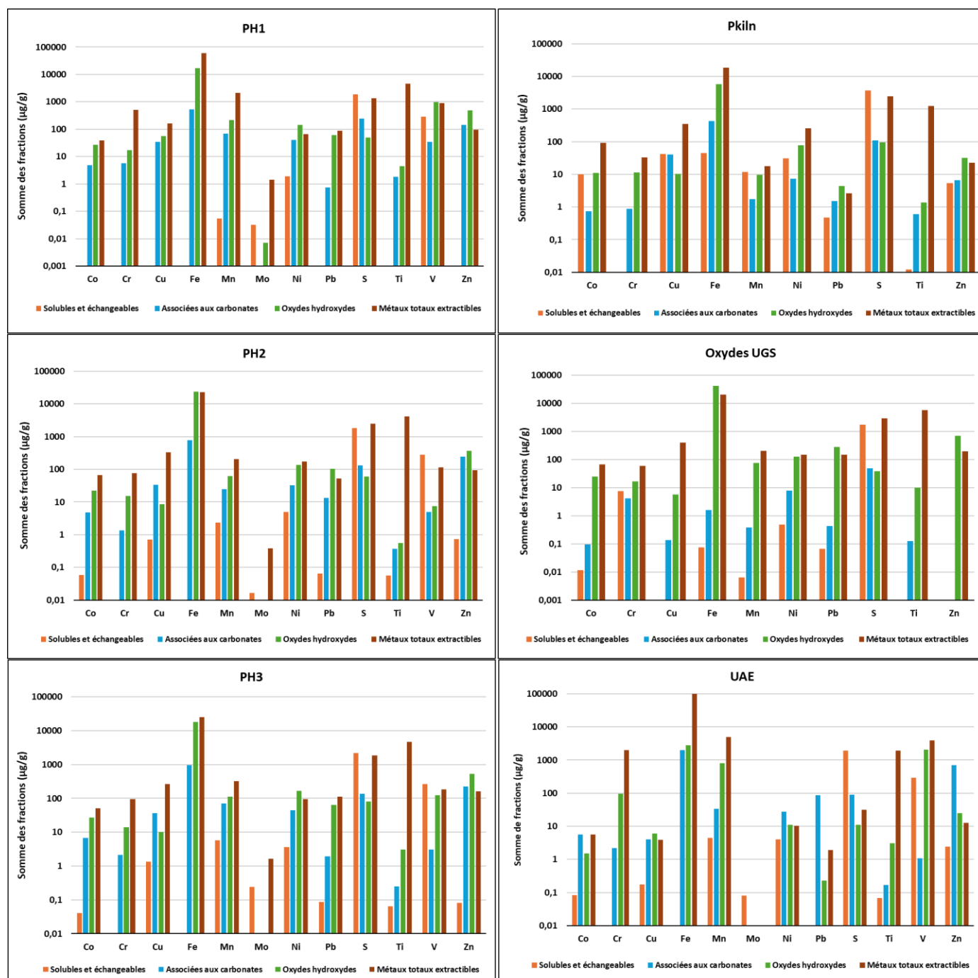
Figure 4.10 : Répartition des métaux dans les fractions de la PES initiale : solubles/échangeable; associées aux carbonates; oxydes/hydroxydes et métaux totaux extractibles
