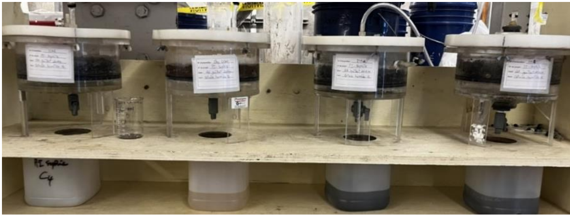
Figure 3.11 : Photo des cellules humides des 4 échantillons scories d'acier Fe-Ti (PH2, PH3, Oxydes UGS et UAE)
