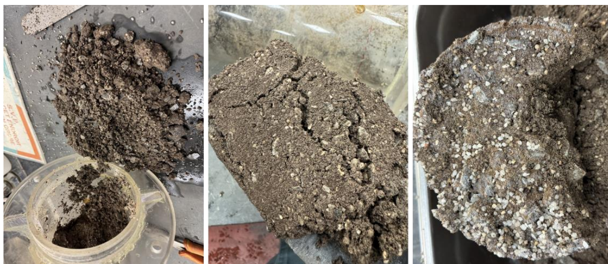
Figure 3.15 : Photo des résidus de oxydes UGS après démantèlement de la colonne
