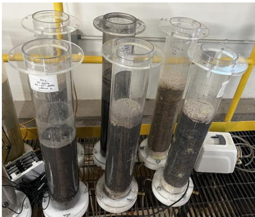
Figure 3.9 : Photo des colonnes en laboratoire après addition des couches de gravier et de silice
