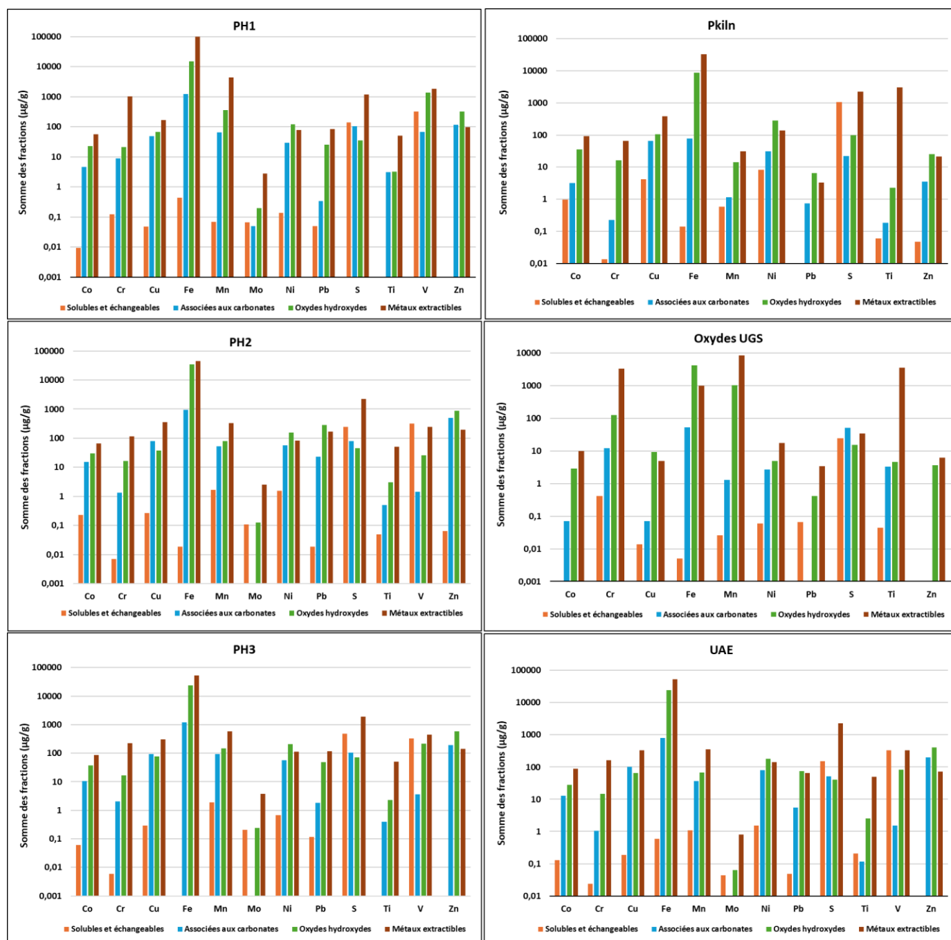
Figure 4.26: Répartition des métaux dans les fractions de PES post-démantèlement : solubles/échangeable; associées aux carbonates; oxydes/hydroxydes et métaux totaux extractibles
