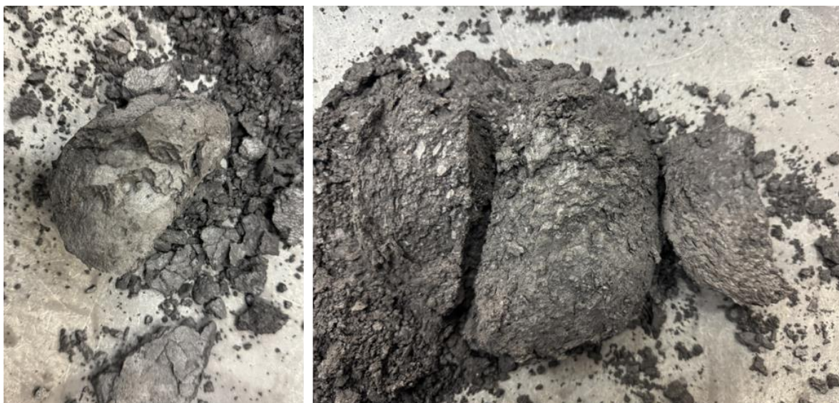
Figure 3.14 : Photo de l'échantillon Pkiln après démantèlement de la colonne
