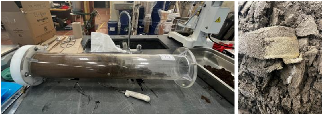
Figure 5.1 : Photos du démantèlement de la colonne d'Oxydes UGS
