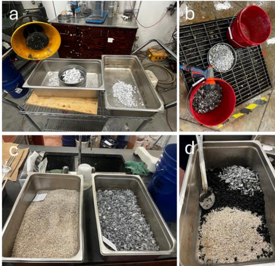
Figure 3.8 : Photos récapitulative de la préparation des matériaux d'amendements (gravier et silice) des scories Fe-Ti : a- tamisage du gravier ( < 415 \mu\text{m} ); b et c- lavage et séchage ( 60^{\circ}\text{C} à l'étuve) du gravier et de la silice; d- mélange du gravier et de la silice avec les échantillons de scories Fe-Ti
