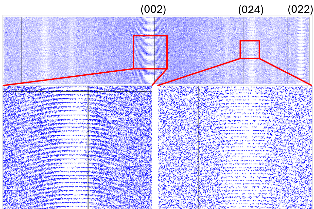
FIGURE 4.5 Détection mesurer dans le temps sur une mesure d'Aluminium dans la direction 002-114
