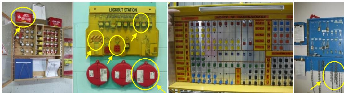
**Figure 5-1 Postes de cadenassage observés dans différentes municipalités avec de gauche à droite (les repères ajoutés) des boîtes de cadenassage, des étiquettes, des morillons, des cadenas, des couvre-valves, des chaînes, etc.**
