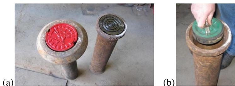
**Figure 6-3 (a) Bouchon de vanne de rue peinturé en rouge, (b) Dispositif testé pour la condamnation du conduit d'accès aux vannes de rues**
