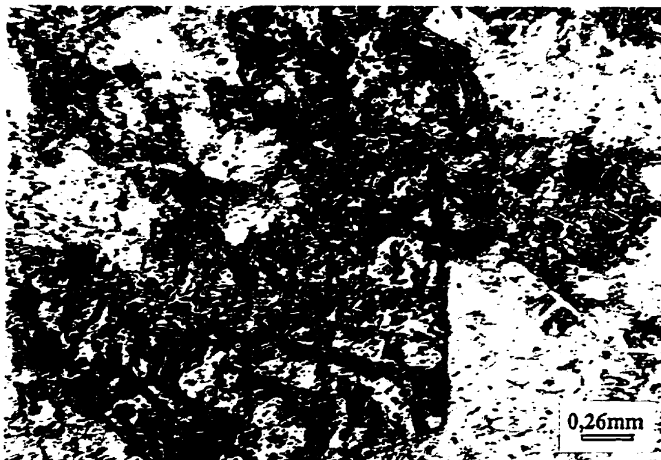
FIGURE 5.43. Grain de magnétite fracturé et corrodé par l'épidote (dans le skarn à amphibole et épidote montré à la figure 5.40). LRN. La pyrrhotite dans les fractures est remplacée presque totalement par la marcassite.
