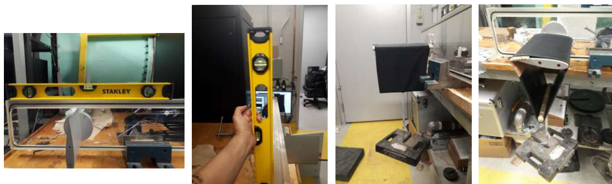
FIGURE 4.14 Procédure de calibration des jauges de contrainte par chargement réparti. Les deux premières images illustrent le positionnement horizontal du profil à l'aide d'un niveau à bulle et d'un niveau numérique. Les deux images suivantes montrent l'application de la charge à l'aide de masses connues, réparties sur toute l'envergure du profil au moyen d'un tissu non élastique.
