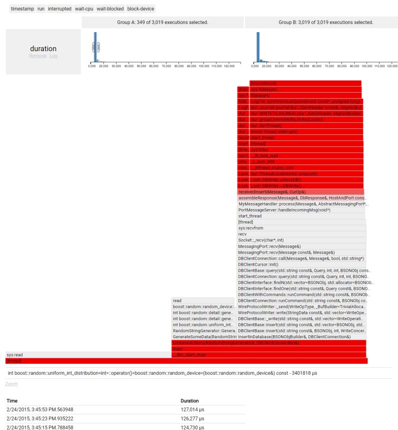
FIGURE 2.8 TraceCompare : graphe de flammes différentiel enrichi
