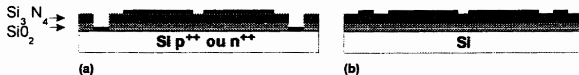
Figure 3.10 Vue en coupe: mise en forme des électrodes. (a) transistors, (b) résistances
