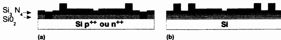
Figure 3.11 Vue en coupe: mise en forme des plots de contact. (a) transistors, (b) résistances
