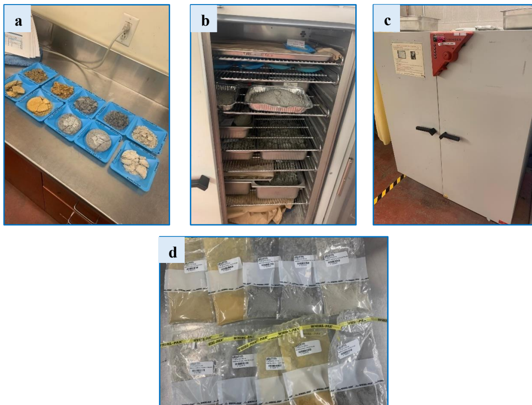
Figure 3.12. Préparation des rejets post-rinçage à des caractérisations et analyses. a) échantillons post-essais ; b) séchage des matériaux à 60 ° ; c) hotte à séchage ; d) échantillons post-rinçage prêts pour les analyses.
