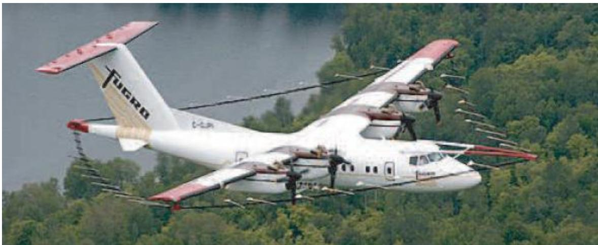
Figure 3-3: Système MEGATEM de Fugro Airborne Surveys.
