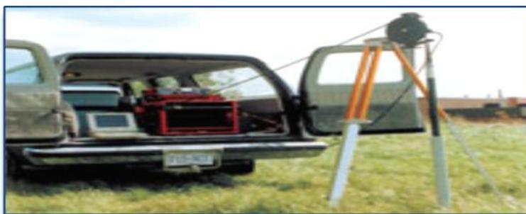
Figure 1-4: Dispositif EM39 pour la mesure de la conductivité et du rayonnement gamma naturel au niveau des forages.
