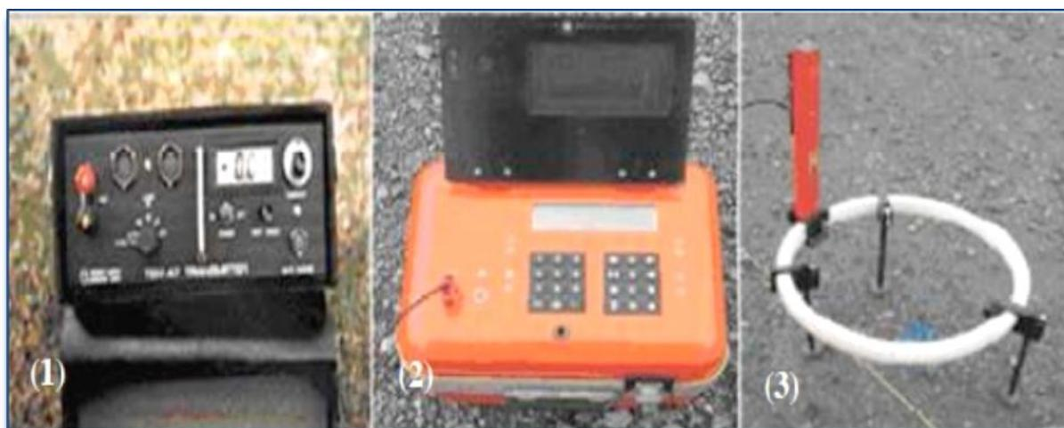
Figure 1-3: Principales composantes du système TDEM Geonics - (1) émetteur TEM47 - (2) récepteur Protém - (3) boucle de réception d'une surface équivalente de 31.4 m<sup>2</sup> (adaptée du manuel de Geonics, Protém-47D).
