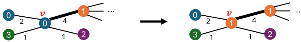
FIGURE 2.2 Exemple illustrant le concept de propagation d'étiquettes dans un graphe. Le sommet v est ajouté à la partition 1 ce qui réduit les communications entre les partitions 0 et 1.
