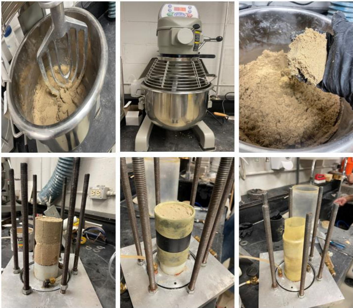
Figure 4.2 Étapes de préparation expérimentale du spécimen dans un perméamètre à parois flexibles.
