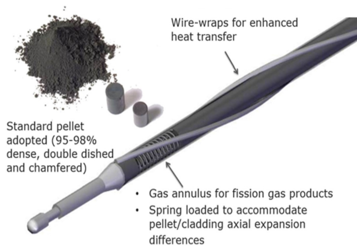
Figure A.4 Vue du crayon de combustible et du lacet enroulé, extrait de [58]
