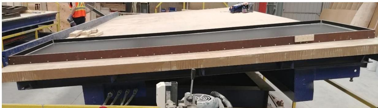
Figure 4.4: Coffrage du panneau en BFUP sur une table inclinable
