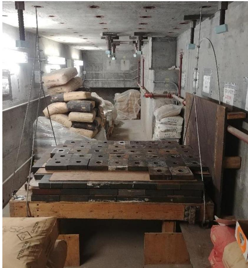
Figure 4.9: Contrepoids au sous-sol pour supporter le poids du vérin
