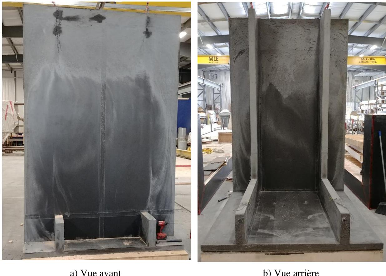
Figure 4.3: Mur de soutènement en BFUP après le démoulage
