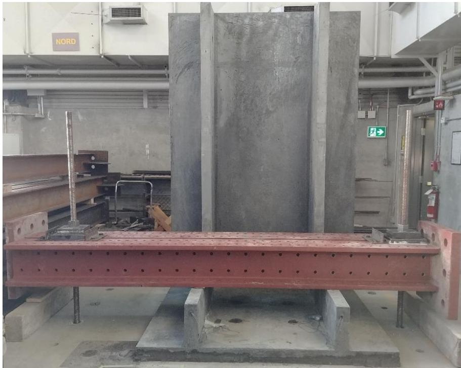
Figure 4.11: Système de fixation de la semelle contre le renversement
