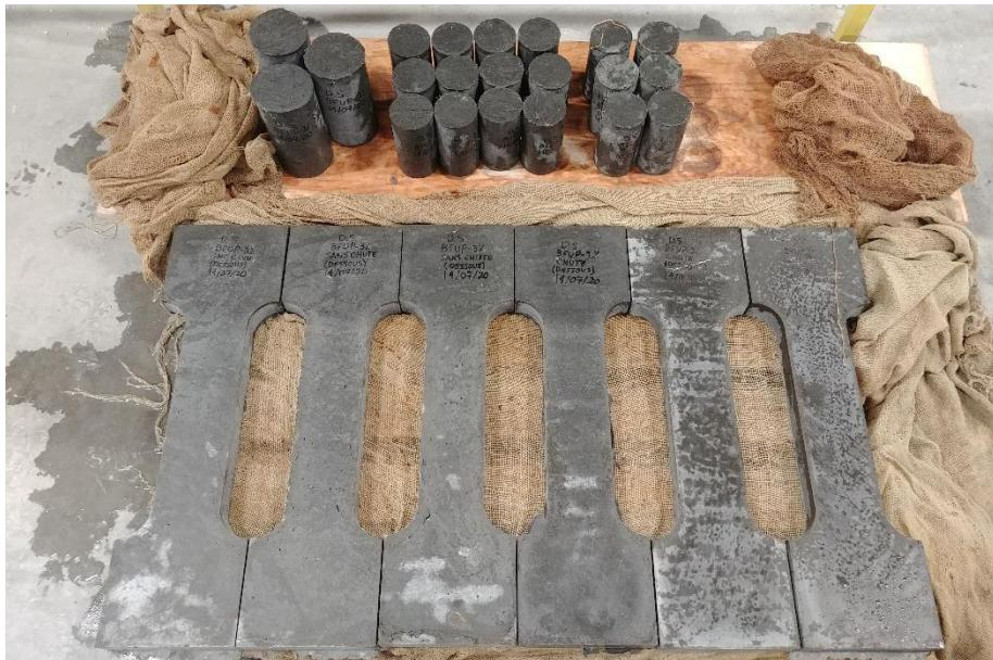
Figure 4.7: Spécimens de caractérisation après le démoulage
