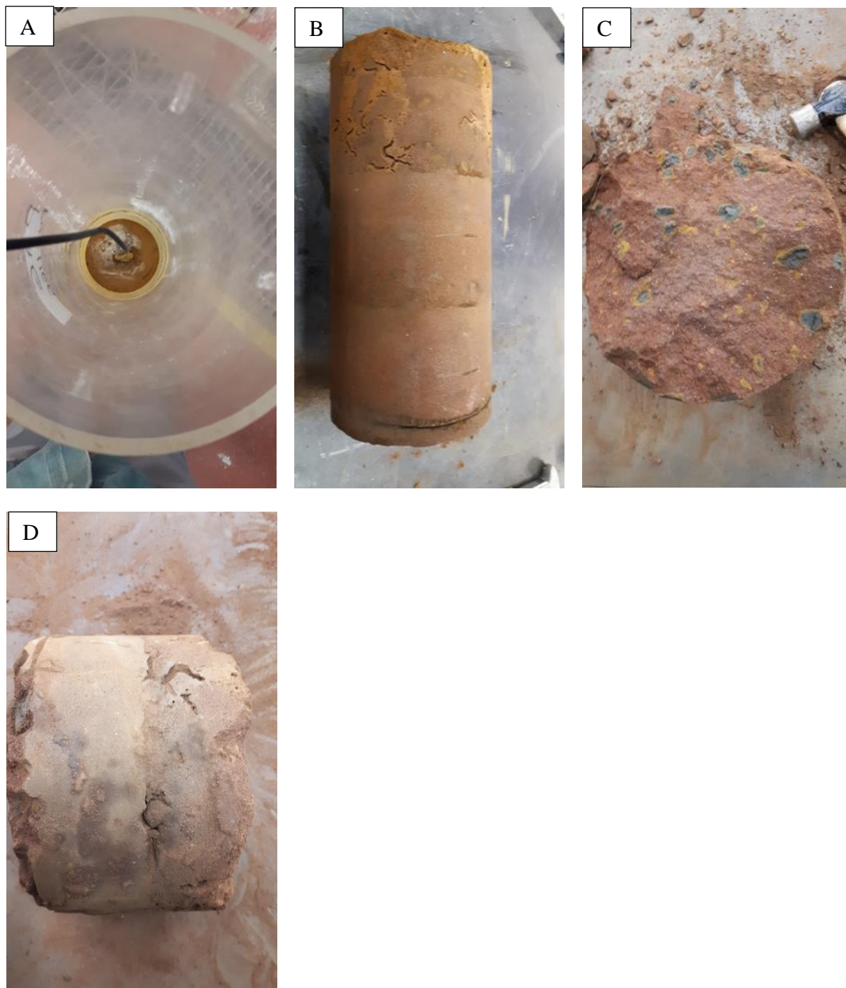
Figure 4.8 Démantèlement de la colonne de résidus PAG (A) Dépôts blanchâtres, (B) Bloc cimenté, (C) Inclusions non-oxydées, (D) Plan de faiblesse
