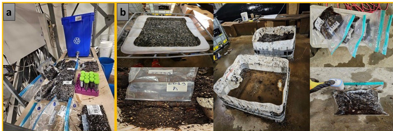
Figure 7.2 Échantillonnage des résidus post-traitement: a) biofiltre de laboratoire, b) biofiltres pilotes de terrain
