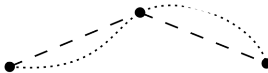
Figure 2.15 Fonctions de forme linéaire et quadratique pour interpolation entre les nœuds.
