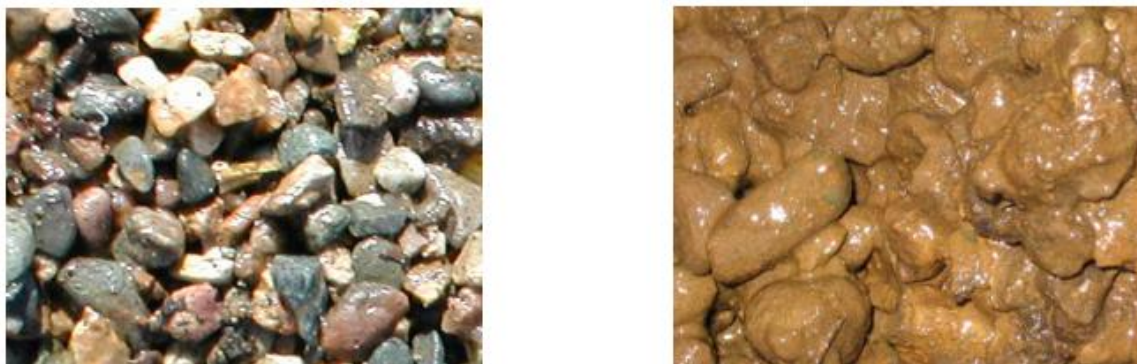
Figure 2-12 Accumulation de \text{Fe}(\text{OH})_3 à la surface du média filtrant du marais filtrant – Taille du gravier : 2mm - 6mm (Nivala, 2005)
