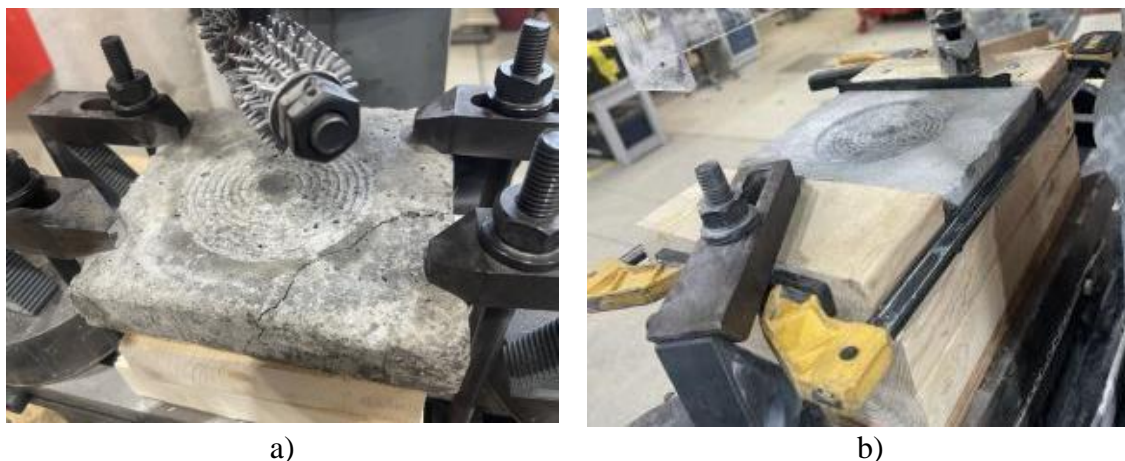
Figure 3.22 Méthodes de fixation du spécimen : a) Serrage direct, b) Serrage indirect
