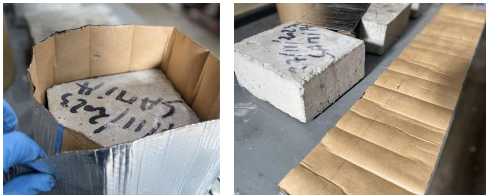
Figure 3.4 Préparation de la membrane Foilskin qui servira à la fabrication de la digue recueillant la solution saline
