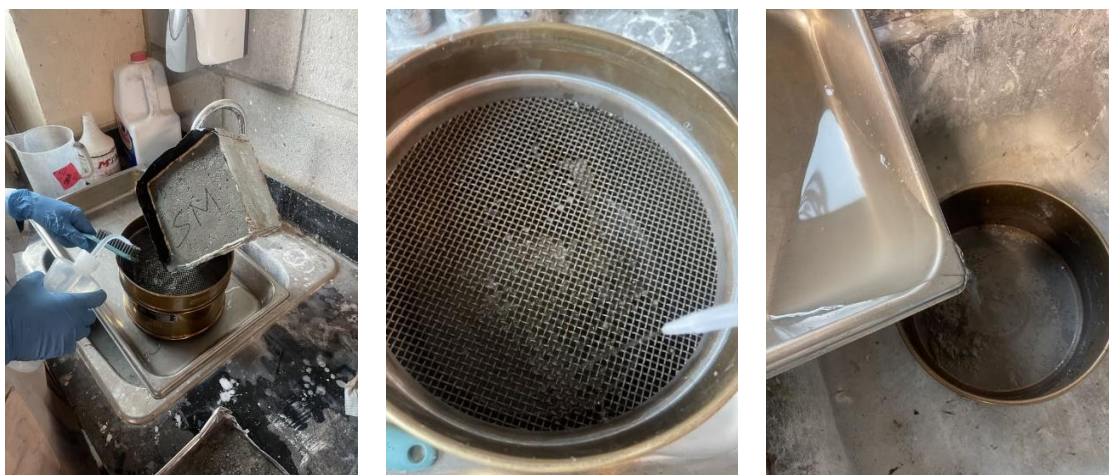
Figure 3.13 Processus de récupération des débris détachés par rinçage dans le tamis de 80 \mu m
