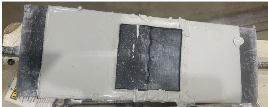
Figure 4.13 Visualisation du joint du tirant en BFUP joint droit2 (après essai et après humidification du tirant)
