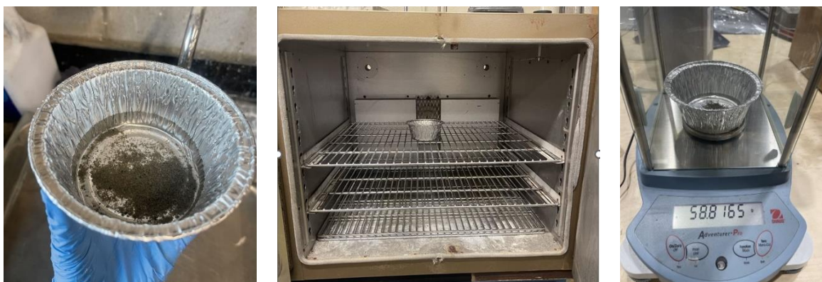
Figure 3.14 Processus de séchage et pesée des débris détachés
