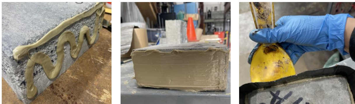
Figure 3.5 Méthodes d'application de la colle et de mise en place de la membrane Foilskin autour du spécimen
