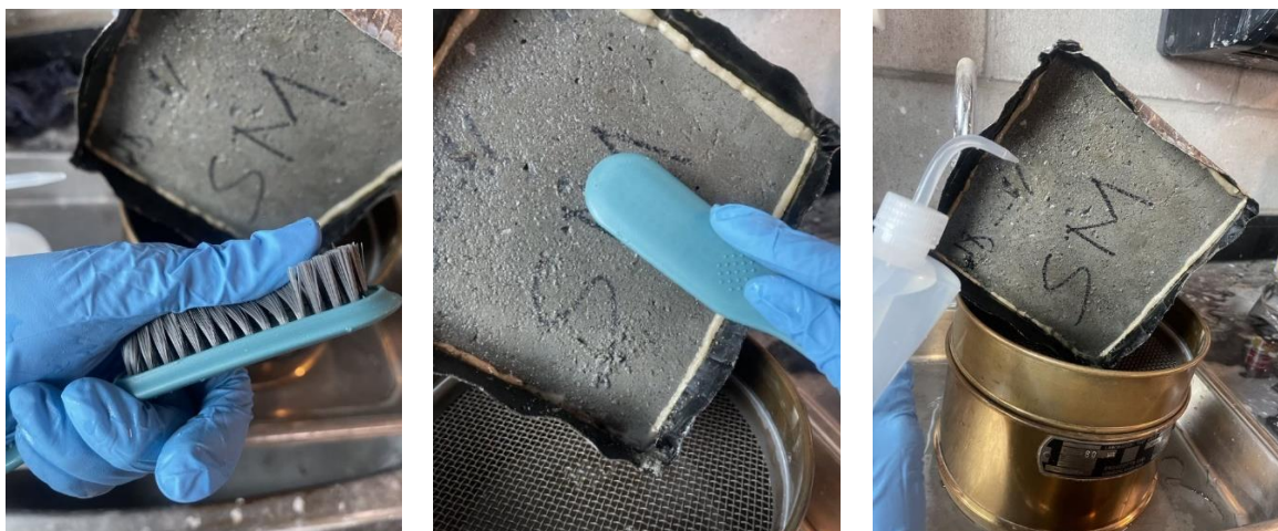
Figure 3.12 Processus de récupération des débris détachés par lavage au-dessus du tamis de 2.5 mm
