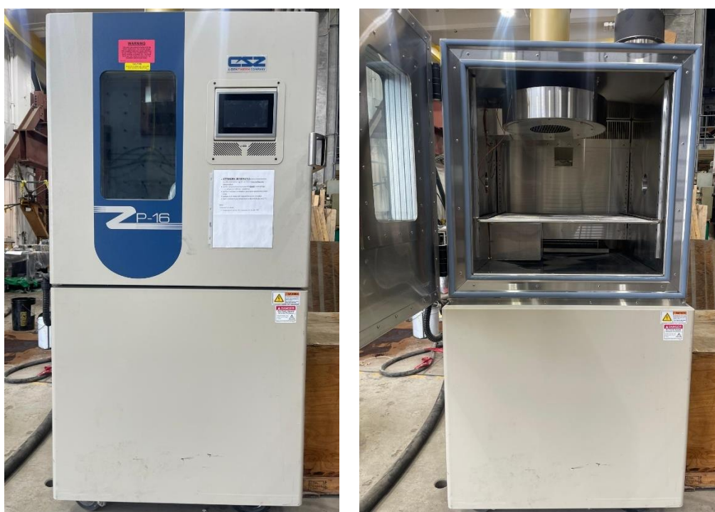
Figure 3.7 Photo de l'appareil de conditionnement utilisé pour l'application des cycles de gel-dégel
