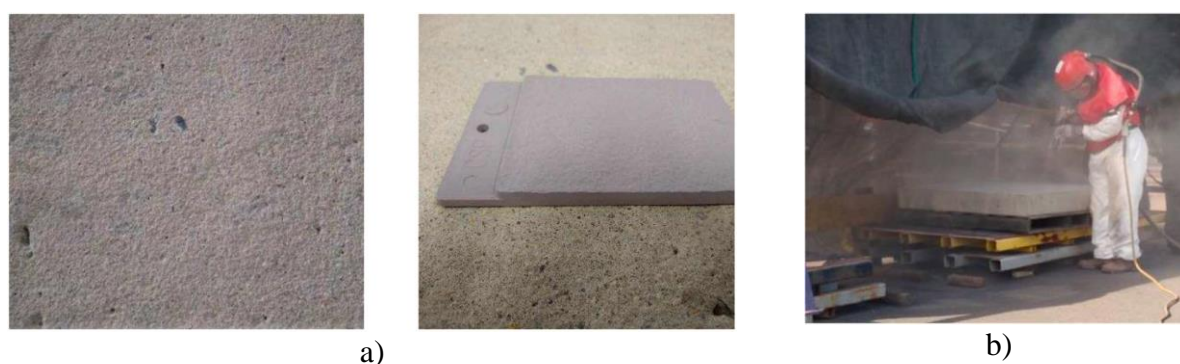
Figure 2.17 Finition de surface par sablage a) rugosité du substrat obtenue b) Équipement utilisé (Helsel, 2023)
