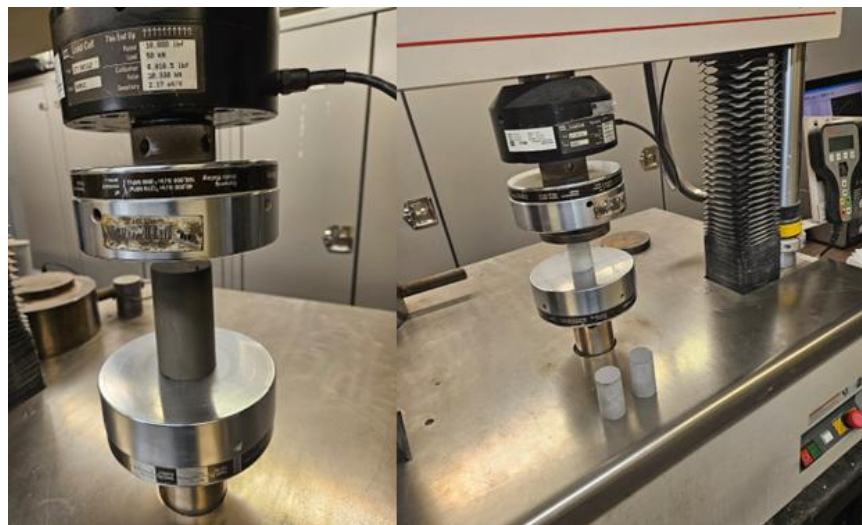
Figure 3.15 Presse mécanique de compression MTS 10/GL de 50 kN de capacité
