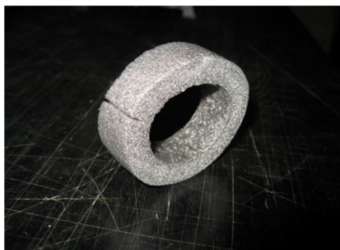
Figure 2.4: Support en mousse de polymère. Le diamètre intérieur est d'environ 3 cm, et le diamètre extérieur est autour de 5 cm. Son épaisseur est de 1 cm.
