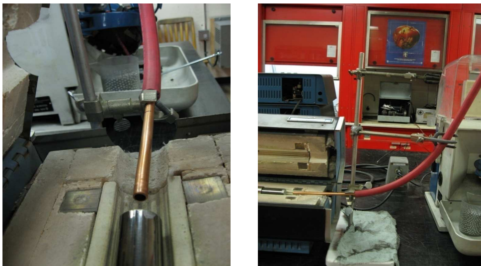
Figure 2.2: Tube en cuivre permettant d'envoyer la bille
