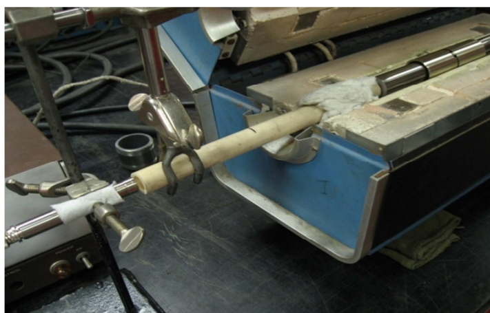
Figure 2.7: Guide d'onde en alumine. Il repose dans le four face à l'échantillon et est suspendu à l'extérieur du four face au microphone (distant de 2 mm de la tige et du microphone).
