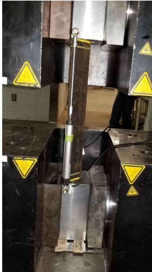
Figure 3-6: Montage utilisé pour effectuer les essais de traction sur cornières (essai sur cornière L64x64x6 montré ici avec lecture par capteur LVDT).
