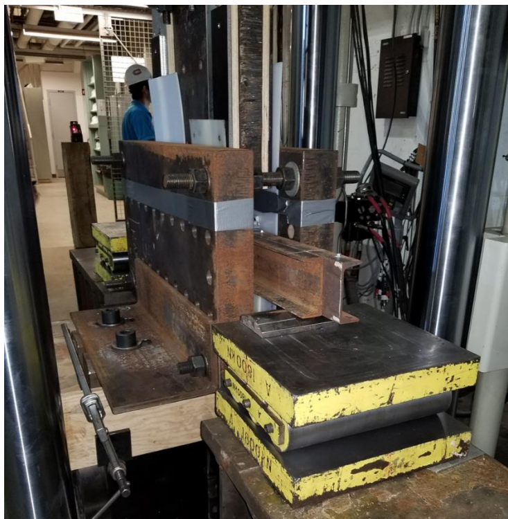
Figure 3-8: Montage utilisé pour effectuer les essais de flexion à 4 points sur profilés en C placés dos-à-dos (essai sur profilés C100x8).
