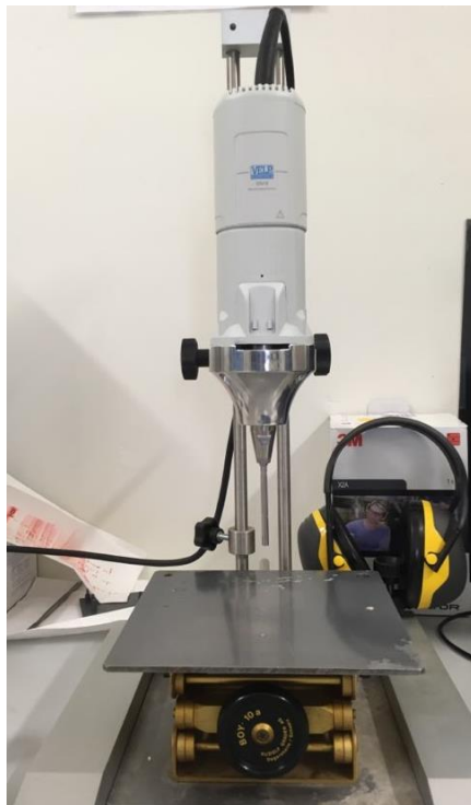
Figure 3.2 Montage expérimental avec l'homogénéiseur OV5
