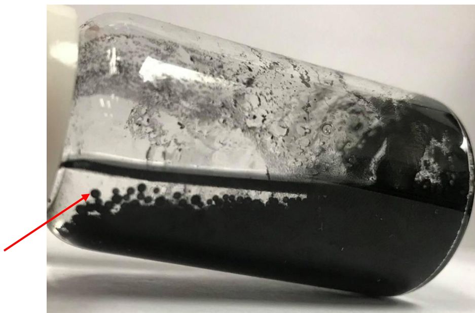
Figure 4.5 Émulsion eau/HS100 stabilisée par 0.15 % de particules de NC
