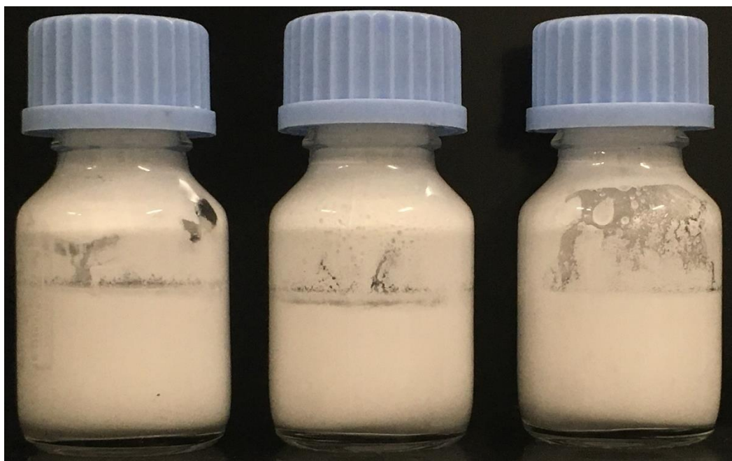
Figure 4.15 Émulsions eau/HS100 stabilisées par 4 % de particules de NBC. Fraction volumique en eau de a) 50 %, b) 55 % et c) 60 %
