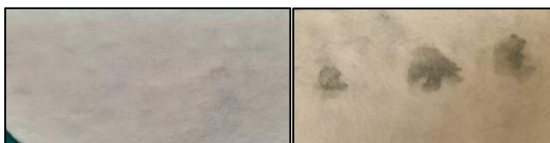
Figure 3-3 : Exemple de Kit Test accepté (gauche) et rejeté (droite)
