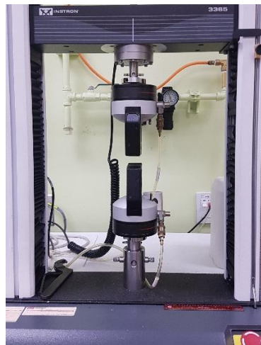
Figure 3-5 : Équipement Instron utilisé pour la résistance à la traction
