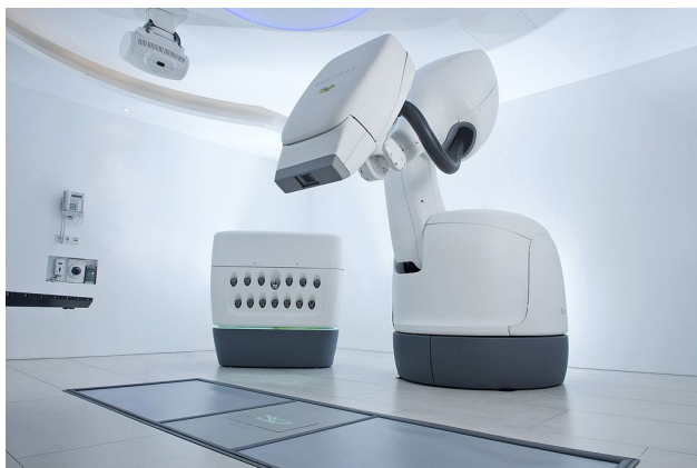
Figure 2.5 Le système de traitement de radiothérapie CyberKnife de la compagnie Accuray. On aperçoit la tête du LINAC montée sur un bras robotique à 6 axes. Le système d'imagerie par rayons X se trouve au plafond avec le détecteur placé sur le plancher. Image tirée de Wikimedia Commons 2021
