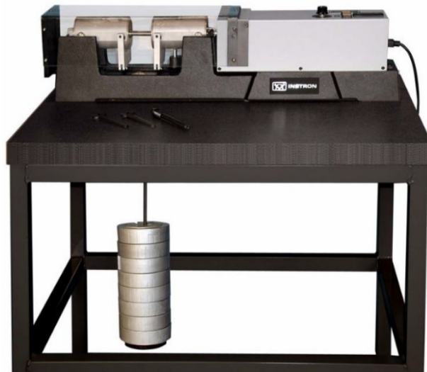
Figure 3.3 Machine R.R. Moore High-Speed Rotating Beam Fatigue Testing produite par INSTRON (SATP1962) [48]
