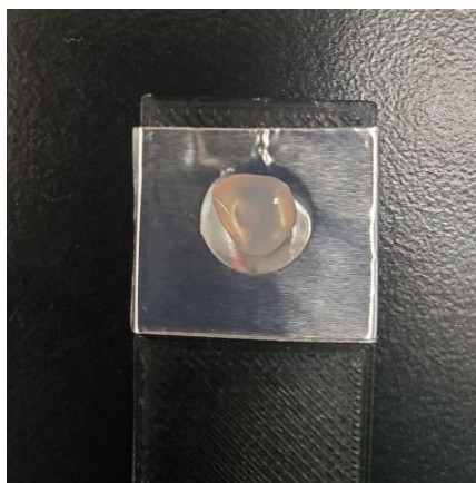
Figure 4.1. Illustration d'une goutte de sang déposée à l'intérieur du puits formé à partir de la cassette. Le volume de la goutte étant de 30\mu\text{L} , et alors que ce puits peut contenir des gouttes allant jusqu'à 60\mu\text{L} , le liquide doit se trouver au centre du puits pour obtenir une mesure fidèle à cet échantillon.
